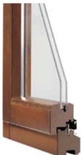
Le finestre e le porte finestre ad una o più ante saranno realizzate con telai in legno di Pino mordenzato, dello spessore nominale di mm. 55, con vetri ad intercapedine 4/9/3+3 per garantire, oltre all'isolamento termico, anche una buona coibenza acustica, completi di maniglia in ottone lucido tipo Ridanna o similare, e di zanzariera.
